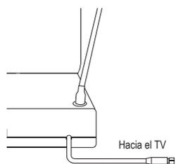
**Aviso:** Si la entrada de la antena de su TV ya está conectada a un receptor de satélite, aparato de cable o convertidor digital, conecte el cable coaxial al conector de entrada de la antena en dicho dispositivo.
