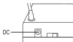
Inserte el adaptador de potencia en el conector de CC de la antena. Conecte el otro extremo a un tomacorriente de pared o extensión.
