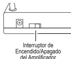
Coloque el interruptor de encendido/apagado del amplificador (ubicado en el panel posterior de la antena) en la posición ON (Encendido).
